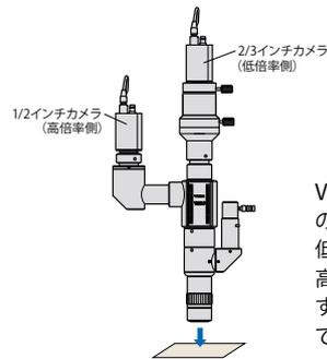
VMU-Lと定倍率観察用カメラマウントの組合せで、各々のCマウント部に低倍率側カメラ(2/3インチ)と高倍率側カメラ(1/2インチ)を装着することにより同一箇所を異なる倍率で観察が可能です。
