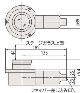
簡易スタンドのベース部に装着して透過照明する場合に使用します。光源は下記のファイバ照明装置(100W/150W)をお使いください。
