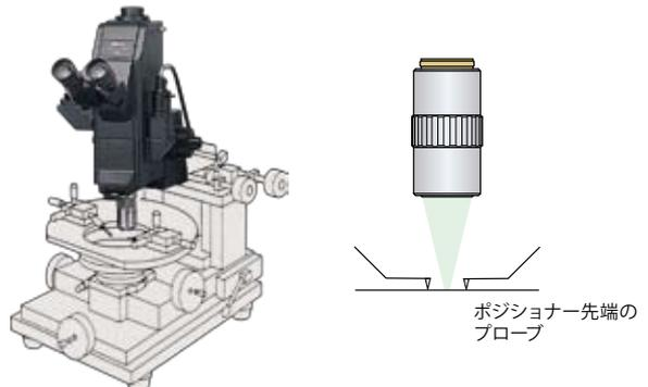
長作動距離の特長を活かした対物レンズを使うことによって、半導体集積回路等の不良解析を目的とした光学システムを構築でき、YAGレーザーを搭載することにより、部分的な微細修正を行うことも可能です。また、ガラス越しや真空内外観検査を目的とした光学システムも提供します。
